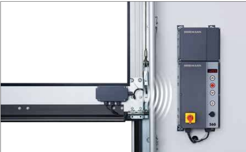
Funkübertragungseinheit zur Übertragung der Signale vom Torblatt zur Steuerung via Bluetooth (keine Wendelleitung), Stromversorgung über eine leistungsstarke Batterie; anschließbare Komponenten: Optosensoren LE (low energy), voreilende Lichtschränke VL1-LE / VL2-LE, 8k2-Leiste, Schlaffseilschalter, Schlupftürkontakt, Nachriegelkontakt
