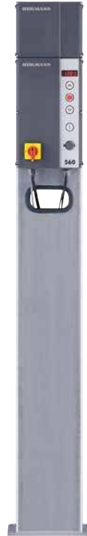
Standsäule ST1 1 zur Montage von max. 2 Steuerungen mit Zusatzgehäuse, Farbe: Weißaluminium, RAL 9006, Abmessungen: 200 × 1660 × 60 mm (B × H × T)
