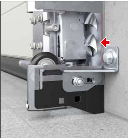
Der Verriegelungshaken der Aufschiebesicherung rastet beim Hochhebeln des Tors automatisch fest ein.
