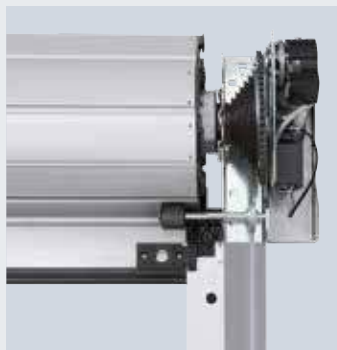
Der kompakte Antrieb WA 300 AR S4 für Tiefgaragen-Roll- tore und Rollgitter TGT benötigt nur 100 mm zusätzlichen seitlichen Platzbedarf auf der Antriebsseite.
