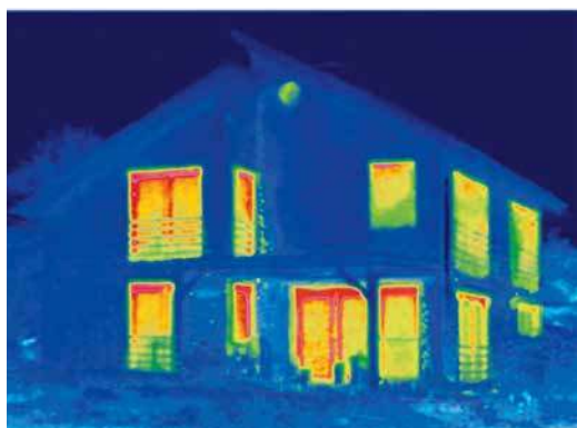
Infrarotaufnahmen, Thermografien, zeigen deutlich, wo ein Haus unkontrolliert Energie verliert. Rot bedeutet Wärme und damit hohen Energieverlust.
